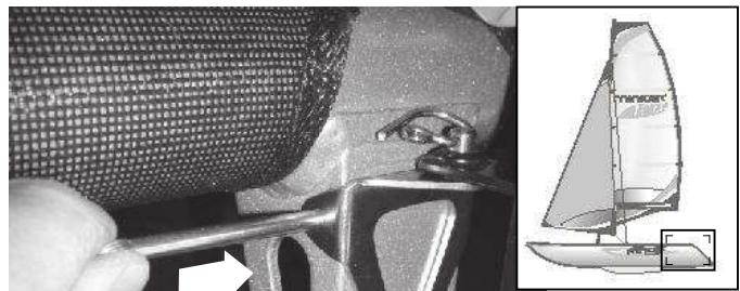
Rozwiń grot i zamocuj V (linkę do podnoszenia) ciągnąc od szczytu masztu do dołu. Włóż żagiel w wycięcie masztu i pociągnij za dźwignię liny, aby ją podnieść. Następnie przywiąż linię do knagi na maszcie.
